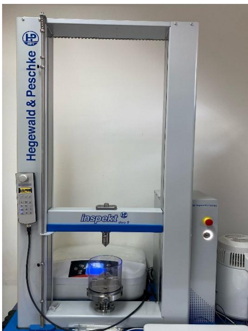
Slika 1. Kidalice Inspekt Duo 5kN; Hegewald & Peschke, Nossen, Njemačka.
