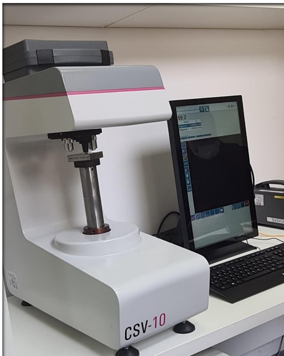
Slika 7. Uređaj za mjerenje mikrotvrdoće ESI Prüftechnik GmbH (Wendlingen, Njemačka).
