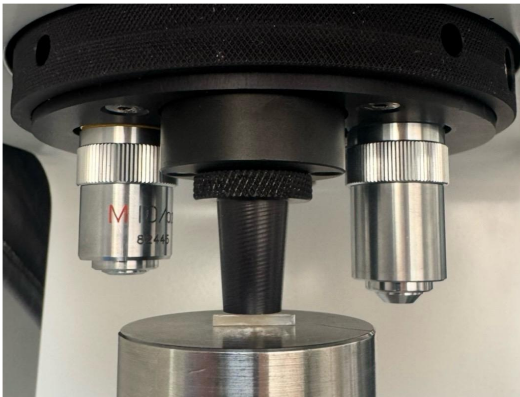
Slika 8. Prikaz poliranog uzorka podvrgnutog testiranju na mikrotvrdoću.
